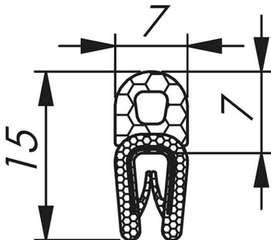
Profil d'étanchéité auto-agrippant fabriqué avec un support en PVC noir avec tube d'étanchéité en caoutchouc (EPDM).
